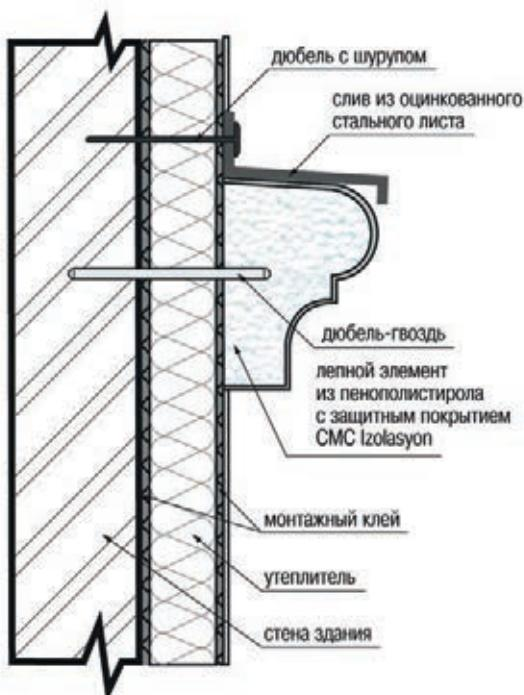
При любом варианте дюбельного крепления дюбели из расчета 4 шт. на 1 погонный метр устанавливаются в стену на глубину не менее 50 мм для полнотелого кирпича и бетона и не менее 90 мм – для всех других материалов.
